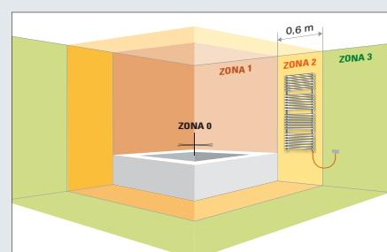
I radiatori elettrici Cordivari sono dotati di resistenza elettrica di classe 1 e grado di protezione minimo IP 44. Ciò consente il loro montaggio in zona 2 di pericolosità a condizione che la linea di alimentazione sia protetta da interruttore differenziale con  $Idn \leq 30mA$ . La presa di alimentazione e l'interruttore differenziale devono essere posizionati obbligatoriamente in zona 3.
